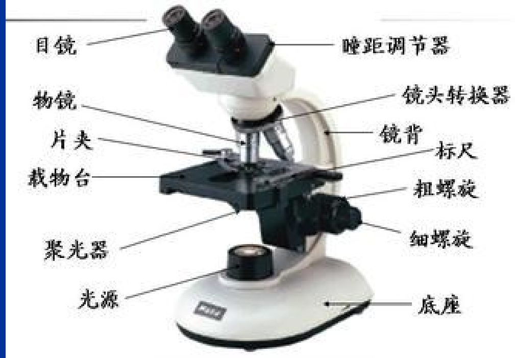
生物显微镜的结构
